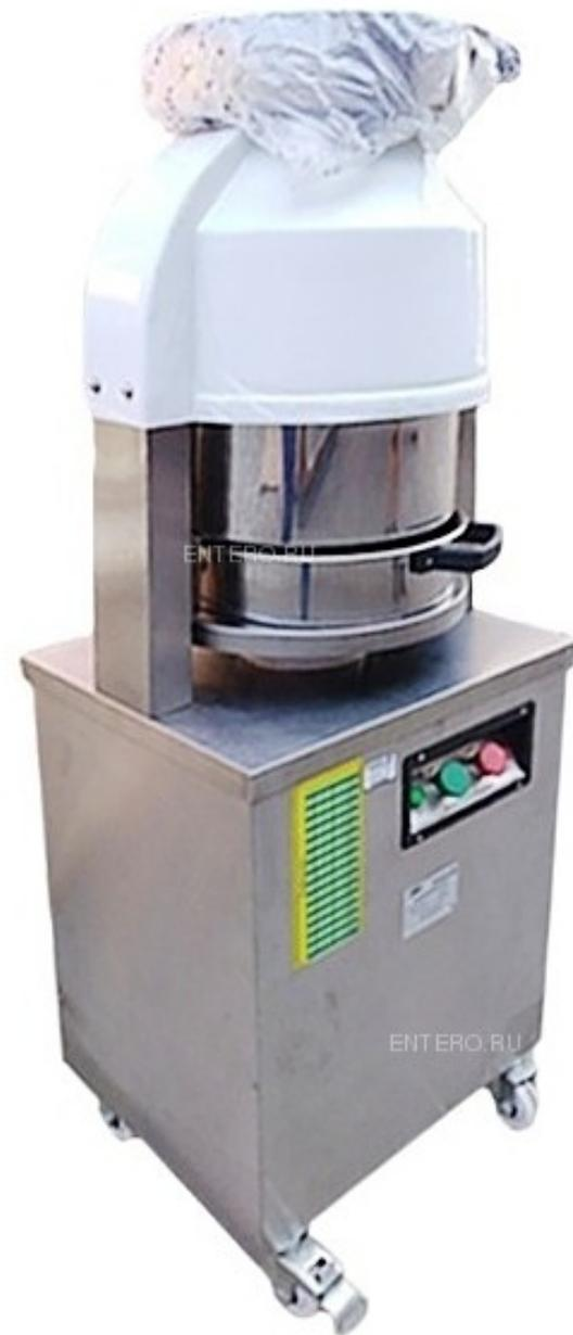
Полуавтоматический тестоделитель **\*\*Foodatlas KZT-36\*\*** используется на предприятиях общественного питания и торговли для деления тестовых заготовок на порции при производстве формового и подового хлеба и мелкоштучных хлебобулочных изделий. Модель оснащена встроенными ножами и колесами. Верхняя
