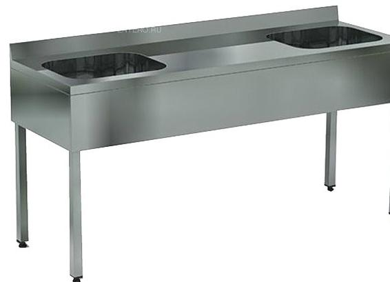
Емкость ванны **\*\*Кобор ВМЦФР/2-210/70 Л/Ц/П\*\*** выполнена из высококачественной пищевой нержавеющей стали, имеет подогнутую кромку для предотвращения травмирования рабочего персонала. Ножки изготовлены в виде уголка 40x40 мм из оцинкованной стали и регулируются по высоте, что помогает избежать наклона рабочей поверхности. Во избежание попадания воды и грязи у ванны имеется борт высотой 70 мм.
